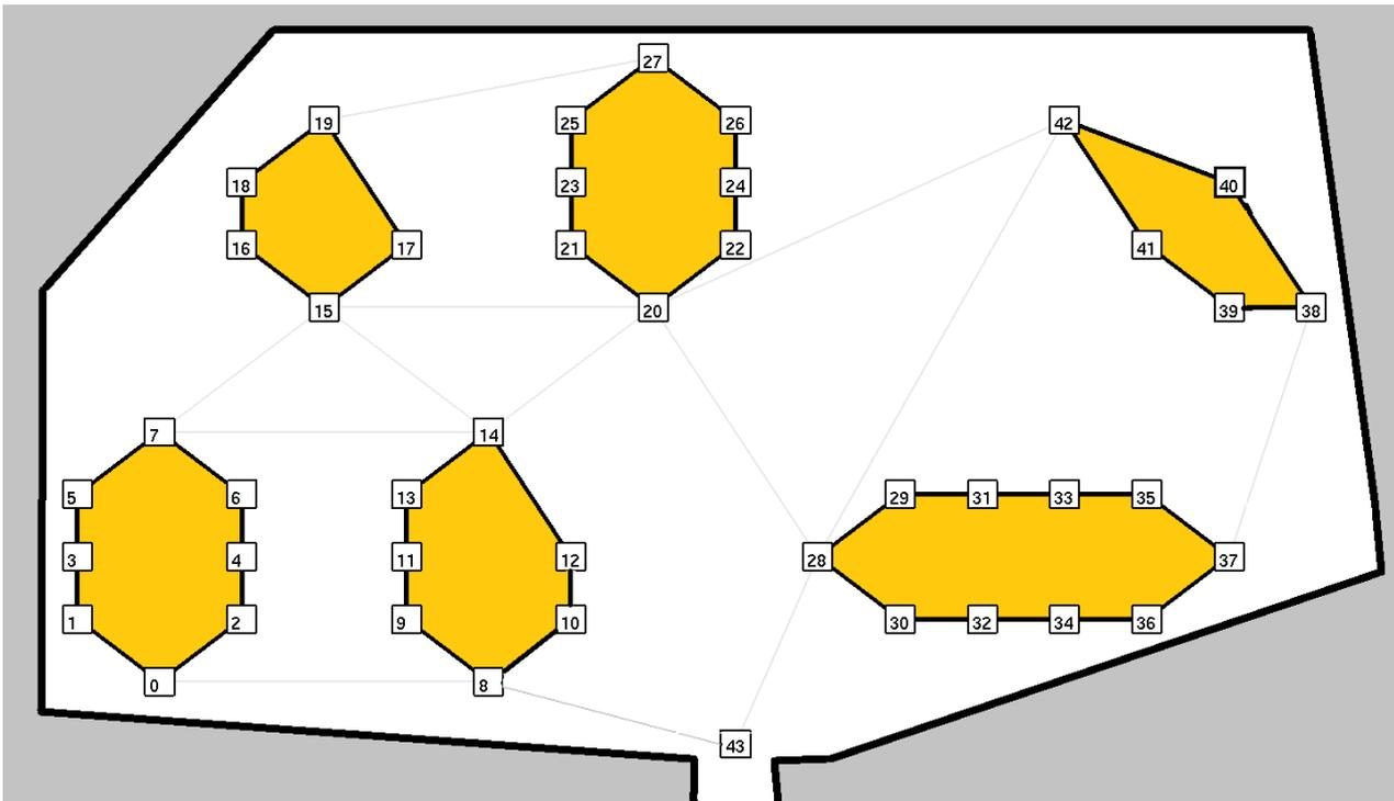
Nous pouvons voir ci-dessus une représentation d'un entrepôt avec 6 rayons et 44 nœuds. **Chaque nœud est placé selon les paramètres Node.X et Node.Y.** et possède une liste de nœuds auxquels il est relié.
