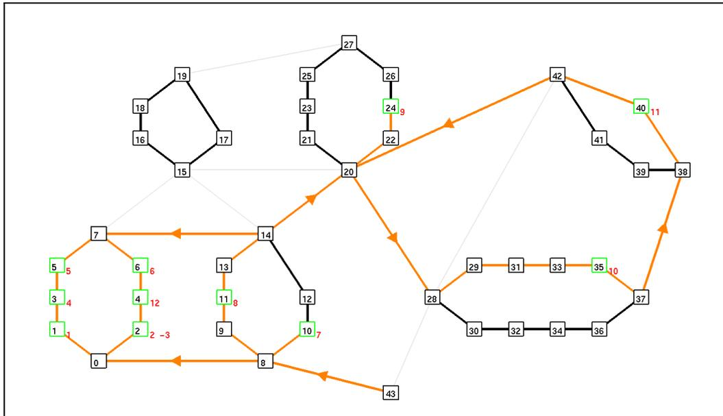
Nous avons également utilisé **OpenGL** pour afficher le chemin le plus court généré par l'algorithme d'optimisation des déplacements. Ce chemin est tracé à l'écran sous la forme de lignes oranges fléchées et d'indices rouges indiquant l'ordre par lequel les articles doivent être pris.
